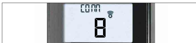
Figur: Synkronisering av Symax pågår
